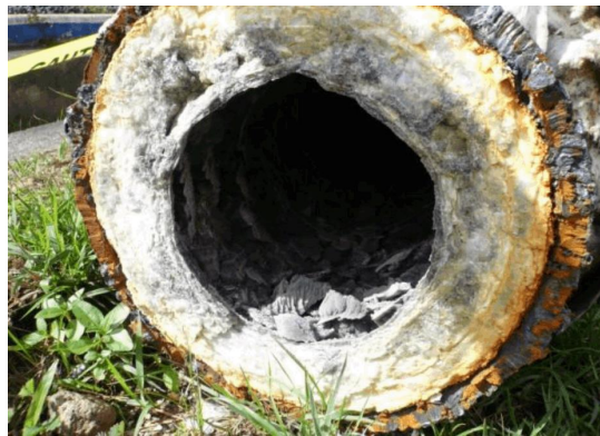
Gambar 1. Silica Scaling pada pipa geotermal (Sumber: Villaseñor, B. L., & Calibugan, A. A., 2011)
