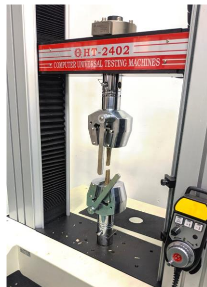
Gambar 4. Proses pengujian tarik
