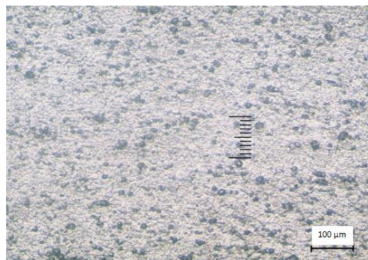
Gambar 6. Struktur mikro daerah nugget ( weld metal )
