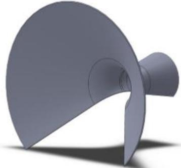
Gambar 2. *Nozzel-Diffuser*
