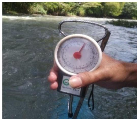
Gambar 8. Pengukuran beban kerja maksimal yang mampu diputar oleh baling-baling
