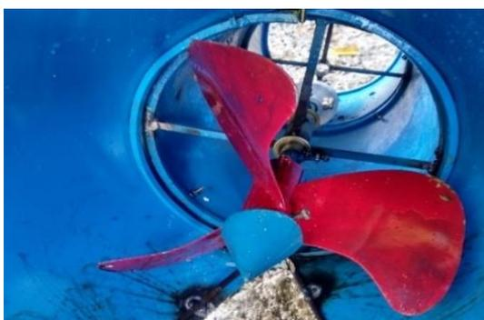
Gambar 6. *Diffuser dan Propeller*
