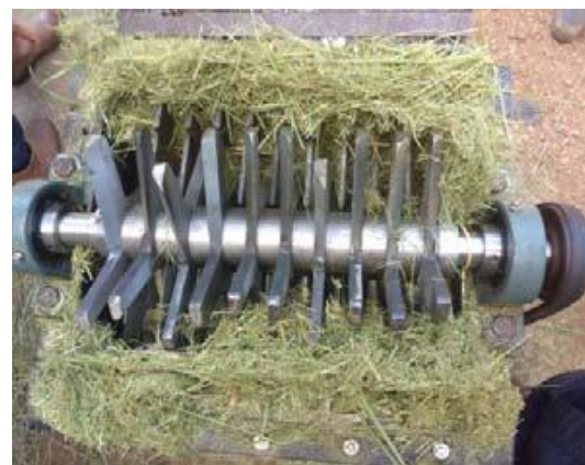
Gambar 1. Hasil cacahan yang cenderung menumpuk pada rumah mesin
