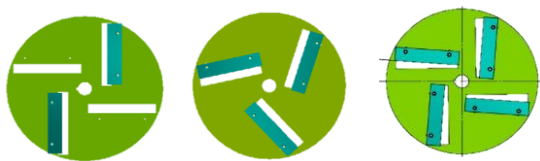
Gambar 6. Posisi pemasangan pisau
