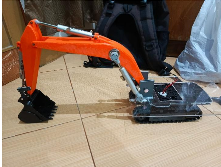
Gambar 4 Prototipe miniature excavator dan bagian-bagian silinder hidrolis
