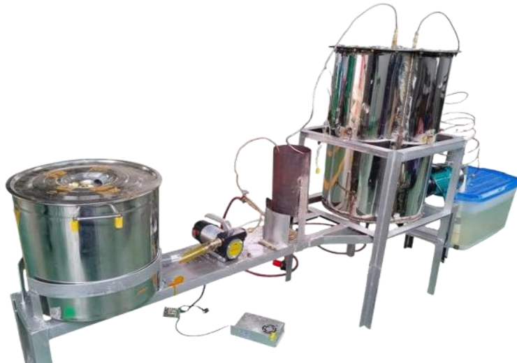
Gambar 1. Prototipe vacuum dryer minyak merah kelapa sawit hasil rekayasa
