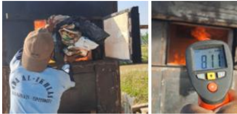
Gambar 7 Proses pengumpanan dan pengukuran suhu ruang bakar
