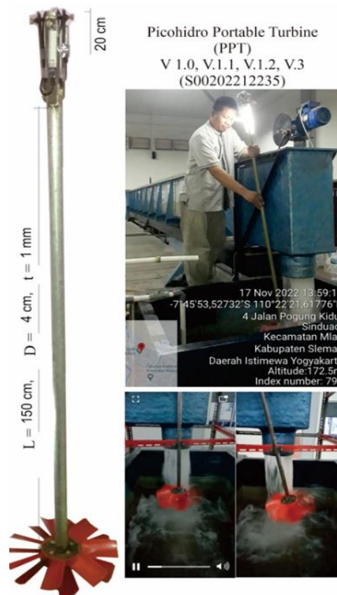
Gambar 1. Turbin Portabel Picohidro
