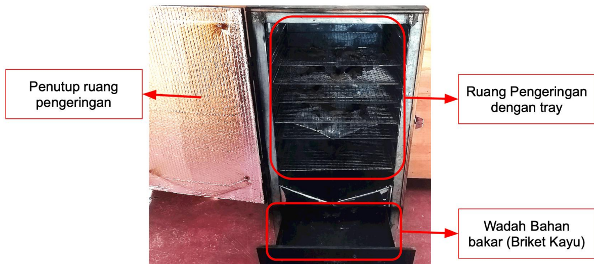
Gambar 1. Food Dehydrator dengan bahan bakar dari briket kayu yang digunakan dalam penelitian ini.
