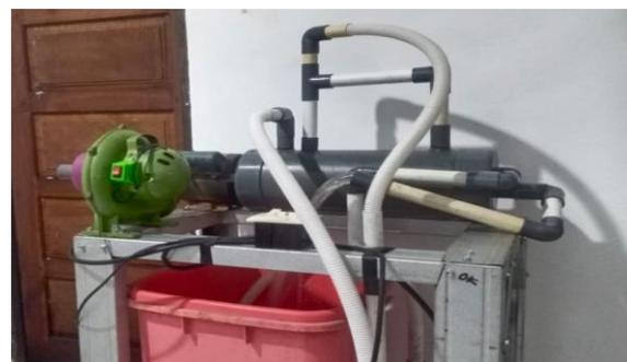
Gambar 3. Prototipe mesin reduktor polutan berbasis sirkulasi air sebagai reduktor
