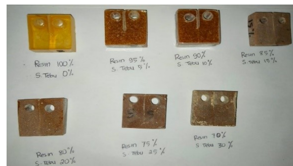
Gambar 7. Spesimen uji retak material komposit
