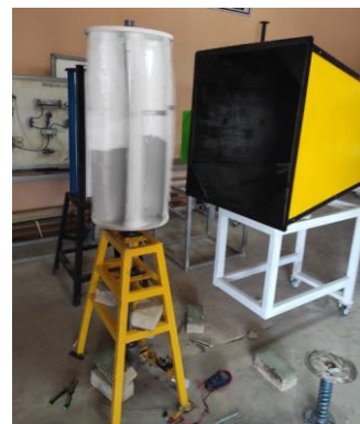
Gambar 5. Proses Pengujian Turbin Savonius Untung mengambil data beban dan kecepatan putaran turbin
