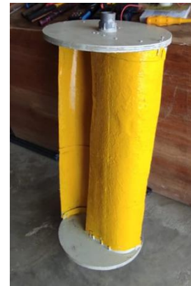
Gambar 4 Turbin Angin Savonius sudu tipe L berdasarkan Spesifikasi pada tabel 1
