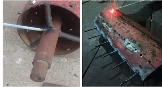
Gambar 3. Proses pembuatan mekanis pengurai sabut kelapa
