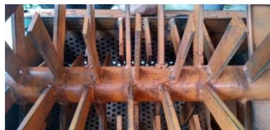
Gambar 1. Bentuk pisau pengurai sabut kelapa (Priono et al., 2019)
