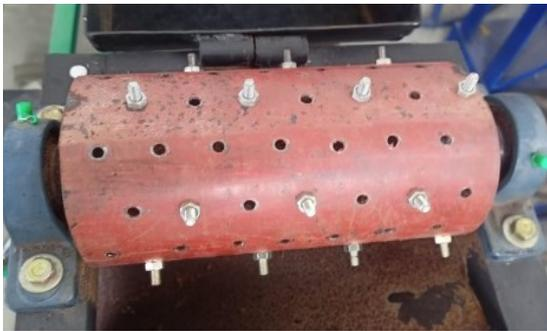
Gambar 2. Bentuk mekanisme pengurai sebelum dimodifikasi (Santoso et al., 2021)
